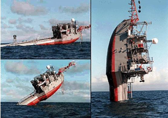
El FLIP es un artefacto de 108 m de eslora, también diseñado en SCRIPPS, que llegado al punto de observación cambia de su posición horizontal de remolque a una vertical. Su diseño le da gran estabilidad y es muy poco afectado por el oleaje.
